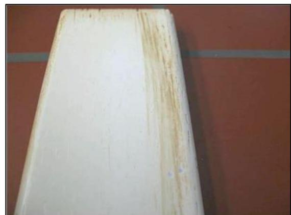
Fig. 2.5 : Altération du système de revêtement par les substances du bois
