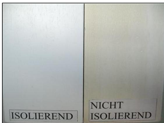
Fig. 2.6: Comparaison de l'effet isolant d'une structure de revêtement avec et sans matériau de remplissage isolant
