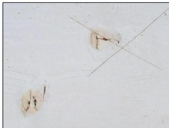
Fig. 2.7: Altérations du système de revêtement par les substances du bois dans la zone des noeuds
